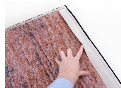
Zdjęcie 1. Zgrzewana taśma
