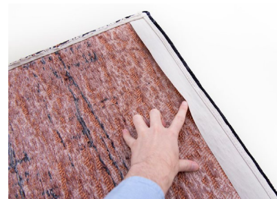
Zdjęcie 1. Zgrzewana taśma
